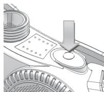
Premendo brevemente il tasto, è possibile scegliere tra due livelli di flusso d'aria: 160 l/min – 210 l/min. La modalità "flusso d'aria massimo" offre una maggior protezione dell'utente. A basse temperature, però, un flusso d'aria maggiore può essere spiacevole.
