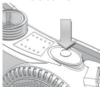
Par une courte pression de la touche, vous réglez le débit d'air délivré à 160 l/mn ou à 210 l/mn. Le débit maximal d'air fournit une protection supérieure mais peut être d'un confort inférieur par faibles températures.
