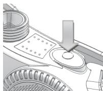
S kratkim pritiskom na gumb lahko preklapljate med dvema nivojema pretoka zraka 160 l/min – 210 l/min. Režim maksimalnega pretoka zraka omogoča višjo stopnjo zaščite uporabnika. Pri nižji temperaturi je lahko višji pretok zraka neprijeten.
