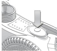
Pulse brevemente este botón para cambiar entre dos grados el flujo de aire de 160 l / min – 210 l / min. El modo de máxima circulación de aire proporciona un mayor nivel de protección para el usuario. Sin embargo a bajas temperaturas, el mayor caudal puede ser incómodo.
