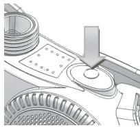
Με τη σύντομη πίεση του διακόπτη γίνεται ρύθμιση μεταξύ των δύο βαθμών του επίπεδου ροής του αέρα 160 l/min - 210 l/min. Η κατάσταση της ροής του αέρα παρέχει υψηλότερο επίπεδο προστασίας για τον χρήστη. Στις χαμηλές θερμοκρασίες όμως, μπορεί η υψηλότερη ροή να είναι δυσάρεστη.
