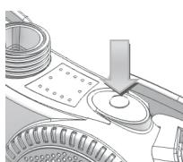
Krótkie naciśnięcie przycisku umożliwia przełączenie pomiędzy dwoma poziomami przepływu powietrza 160 l/min. – 210 l/min. Nastawienie maksymalnego przepływu powietrza zapewnia wyższy poziom ochrony użytkownika. Jednakże przy wyższych temperaturach powietrza jego zwiększy przepływ może być nieprzyjemny. Jednostka filtrująca AerGO® została wyposażona w wysoce zaawansowany system sterowania ciągłego przepływu powietrza oraz w system ostrzegania użytkownika.
