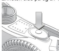
Ved å i kort tid trykke på knappen, er det mulig å slå over mellomto ulike styrker luftstrøm: 160 l/min – 210 l/min. Moduset for maksimal luftgjennomstrømning gir brukeren større beskyttelse. Dersom temperaturen i omgivelsene er lav, kan det imidlertid være ubehagelig når luftstrømmen er stor.
