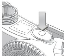
Durch kurze Betätigung der Drucktaste kann zwischen den beiden Stufen des Luftstromes, 160 l/min – 210 l/min, umgeschaltet werden. Der höhere Luftstrom gewährt dem Benutzer ein höheres Schutzniveau. Bei niedrigen Temperaturen kann jedoch eine höhere Strömung unangenehm sein.
