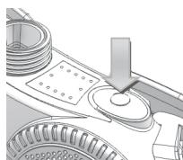
Genom en snabb knapptryckning kan man ställa om mellan två luftflödesnivåer: 160 l/min – 210 l/min. Det maximala luftflödet ger störst skydd. Vid låga temperaturer kan dock det starkare flödet vara obehagligt.
